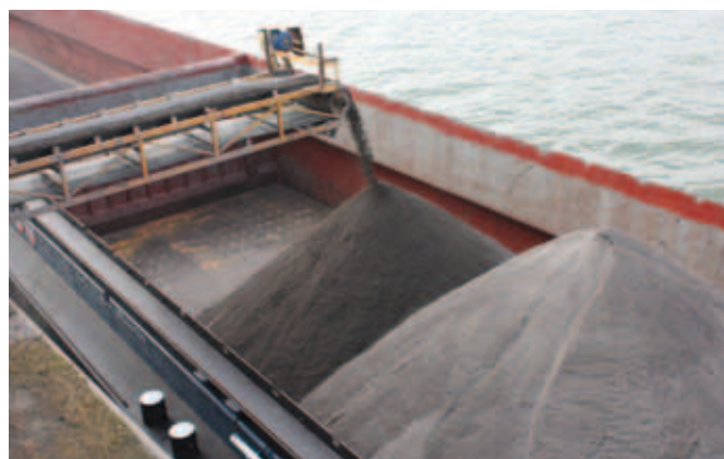
Bande transbordeuse. ©SPW-DPVNI
