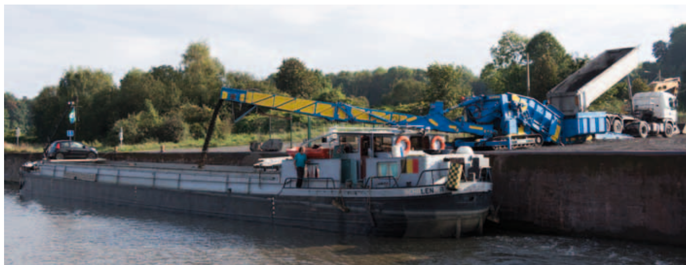
Équipement mobile de transbordement direct camion-bateau. ©SPW-DPVNI
