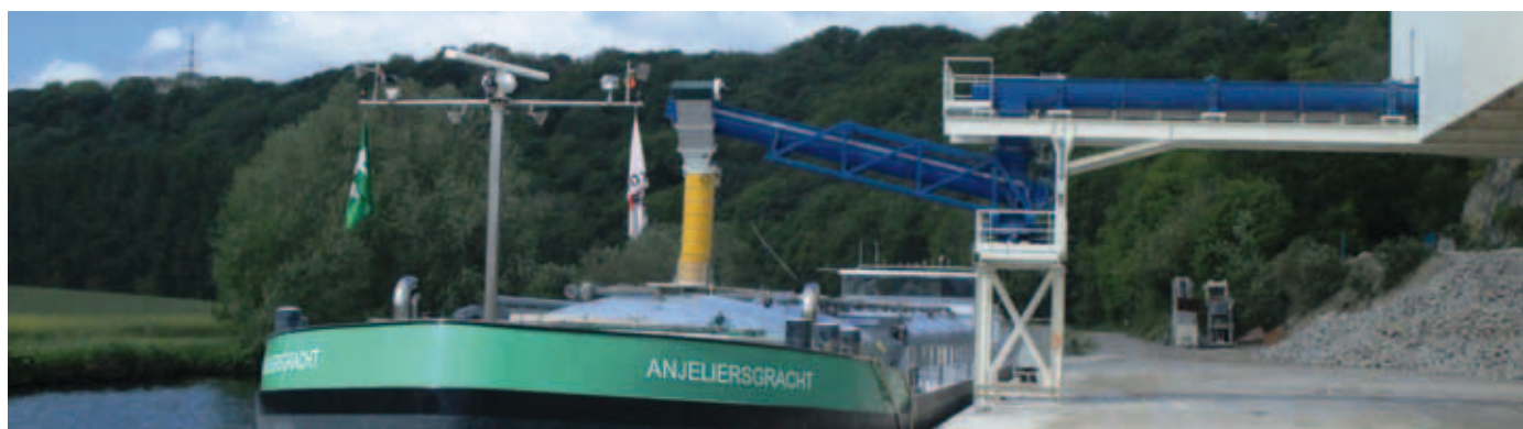
Chargement de filler calcaire. © Calcaires de la Sambre
