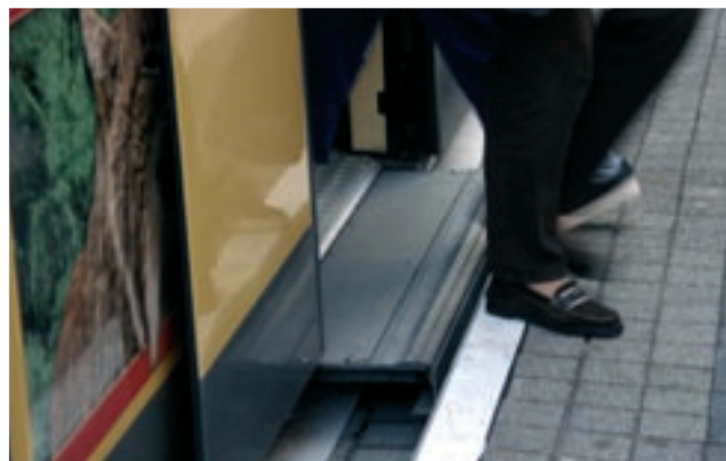
Plancher-quai pour une meilleure accessibilité. Source : ICEDD.
