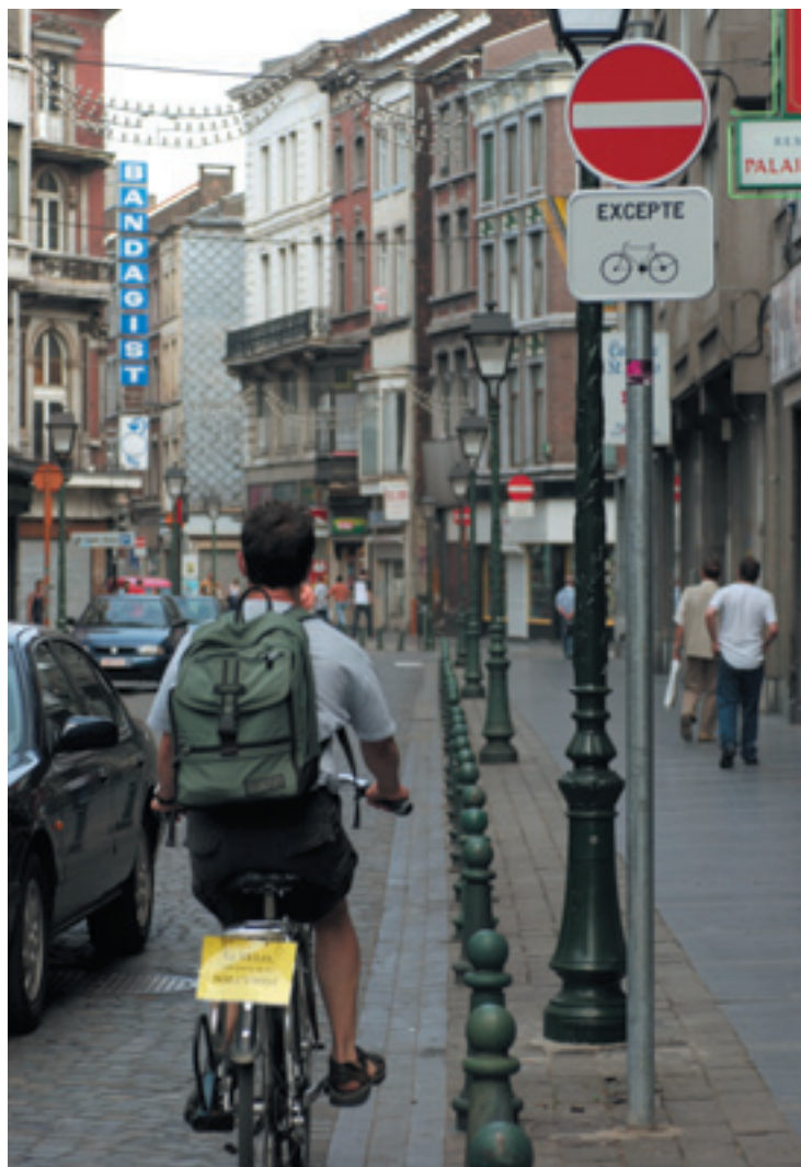
Aménagement d'un sens unique limité. Source : MET-D434.
