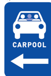
400x600mm quantité 9 Txt 40mm Picto 220mm haut Flèche 300x120mm Alignements idem F59
