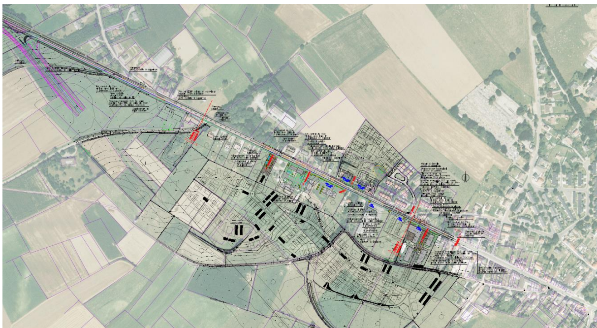
Figure 184. Réfection de la Chaussée de Wavre prévue (charge de lotissement) avec une piste cyclable bi-directionnelle le long de la chaussée de Wavre et des bandes de tourne-à-gauche (Source : administration communale de Jodoigne)
