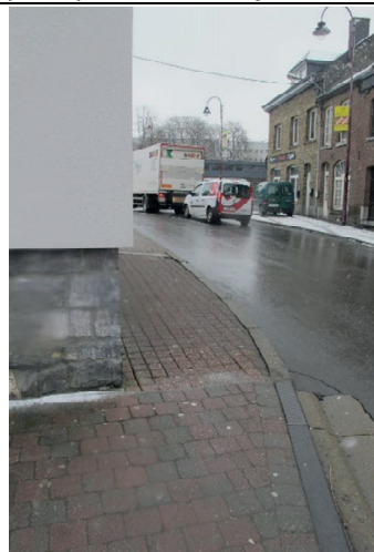
Accès aux arrêts depuis la rue de la Pépinière : libre passage trottoir insuffisant : 130 cm réduite à 90 cm à l'angle du bâtiment + stationnement.
