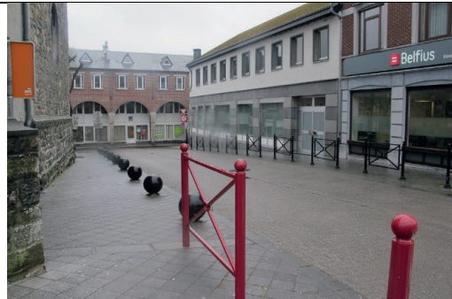
Porte de Trèves : les barrières sont conformes, par contre les boules noires constituent un danger pour les personnes déficientes visuelles (obstacle difficilement visible, risque de basculement par-dessus)
