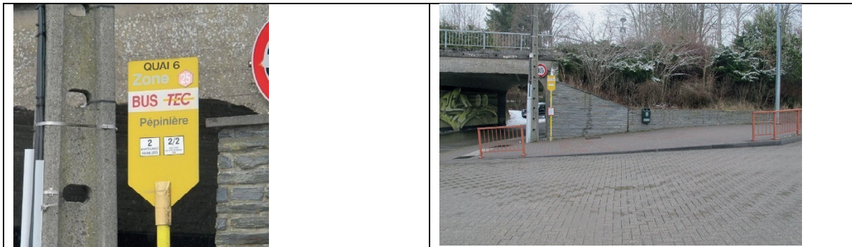
Quai 6 (lignes 2, 2/2) impraticable pour personnes en fauteuil roulant : pente 9%
