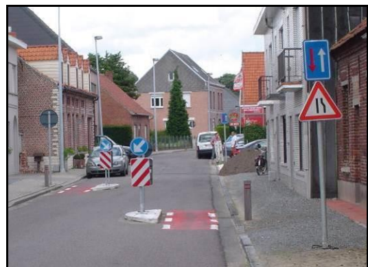
Chicane avec bypass ➔ pas faisable si stationnement de part et d'autre
