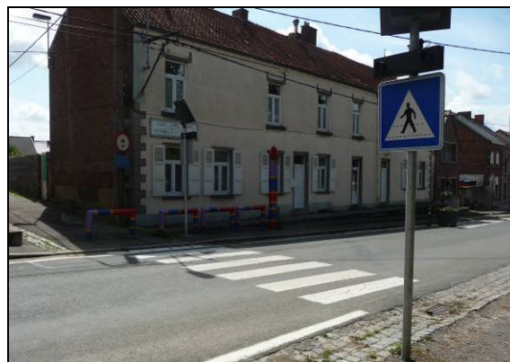
Signalisation sommaire du passage piétons Barrière colorée pour protéger l'accès à la venelle Eclairage dans la venelle qui donne sur le passage piéton.
