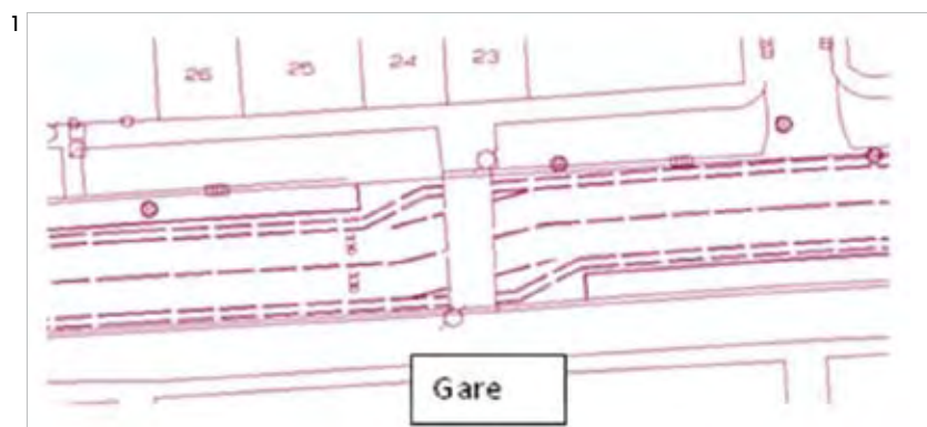
1. Aménagement cyclable au niveau du feu piéton.
