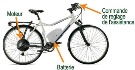
Figure 45. Eléments du fonctionnement du VAE
