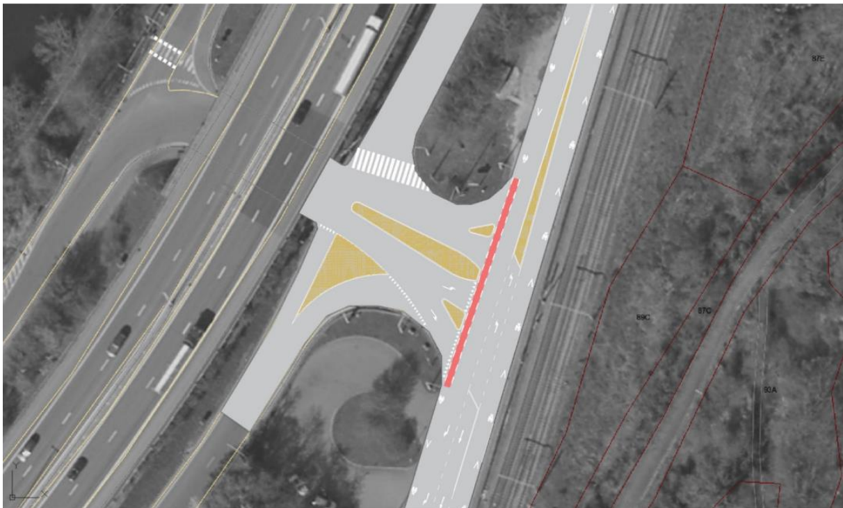
Figure 80 : aménagements directionnels canalisant les flux – ilots franchissables en béton coulé bombé
