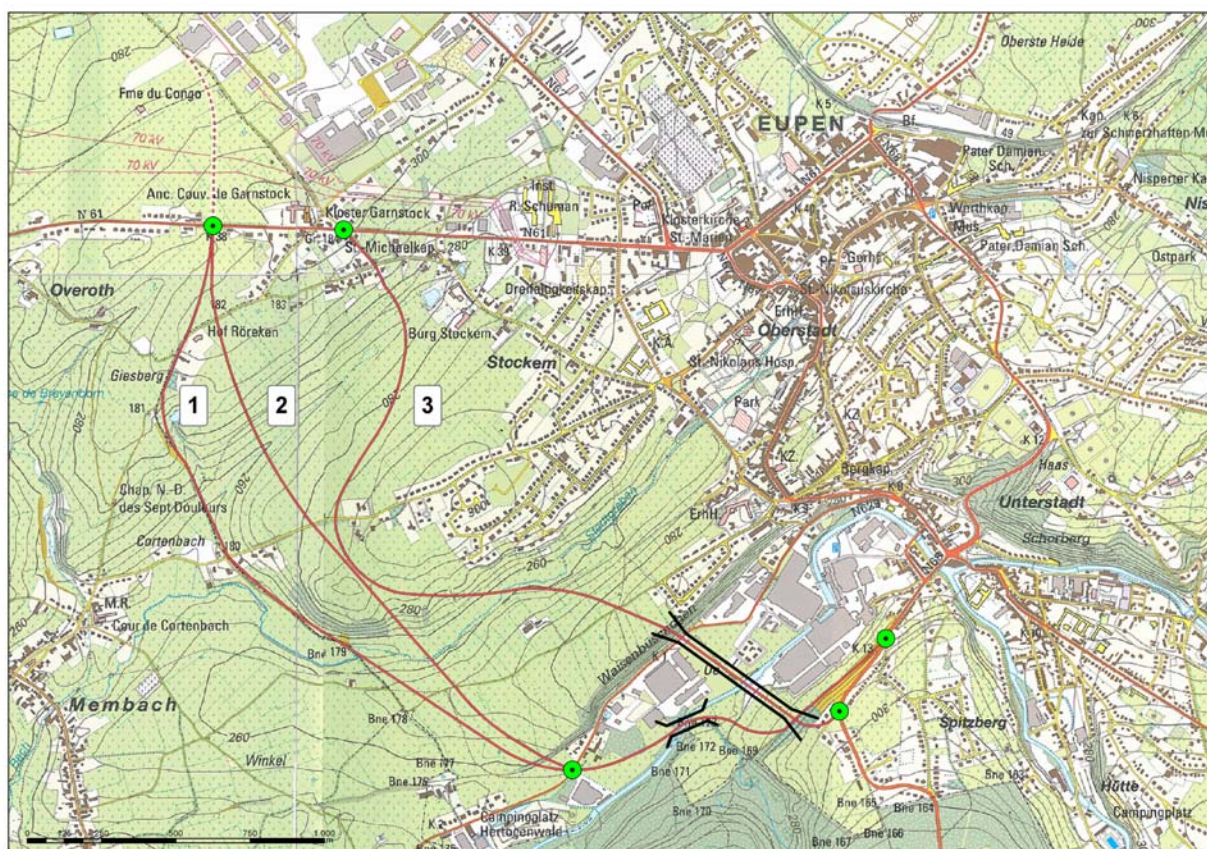
Figure 3.1: Variantes possibles pour le tracé du contournement Eupen ouest
