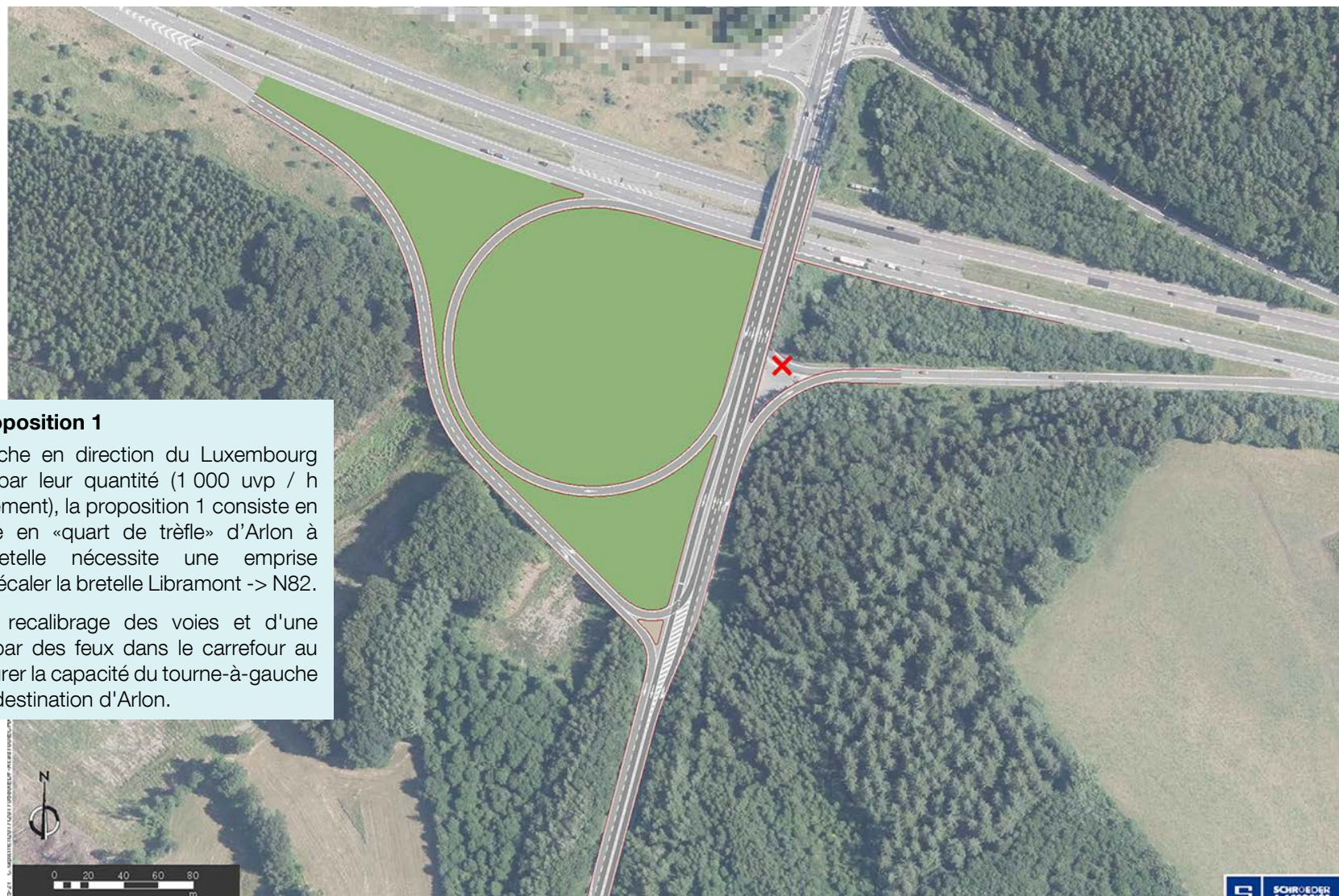
Figure 20 – Esquisse d'aménagement de l'échangeur d'Arlon – proposition 1
