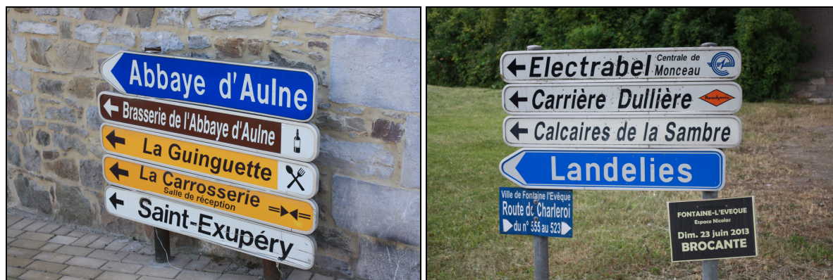
Figure 5 : Exemples de mauvaise hiérarchisation des signaux de direction
